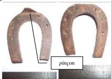
dessus dessous Dimensions maximales : 100x115x9mm Il a 6 trous carrés et 1 pinçon. Il pèse 345g Sans doute pour patte . arrière
